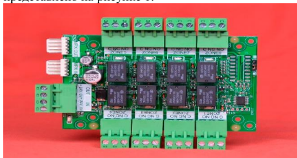
Рисунок 1 – Расположение входов/выходов модуля реле
